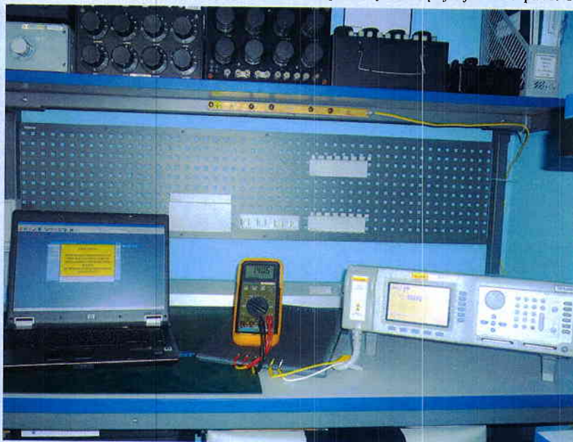
Рис. 7 Вид рабочего места поверителя, выполняющего автоматизированную поверку мультиметра МУ 64
